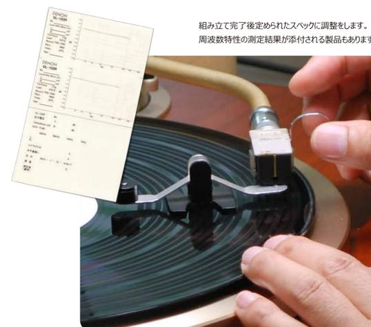
組み立て完了後定められたスペックに調整をします。
